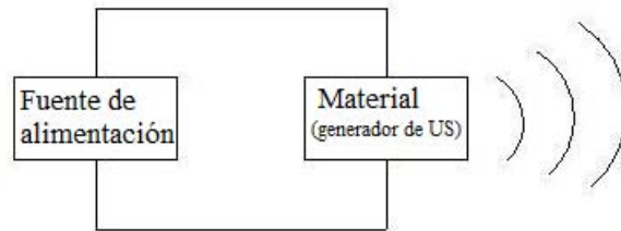
Figura 2.1 Diagrama que muestra la generación del ultrasonido con material resonante en ondas ultrasónicas.
