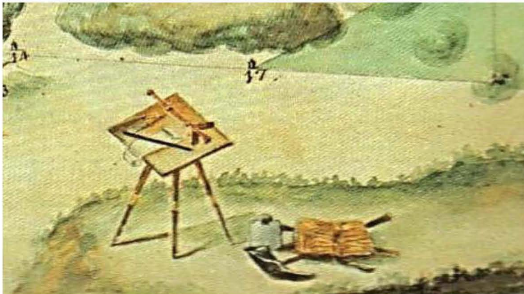
Detalle del plano “Hacienda de Mazapa” en el Estado de México, de Ignacio de Castera en donde se pueden ver ilustrados los utensilios utilizados para el levantamiento, entre ellos destaca el empleo de la plancheta, la cual aparece en el tratado de Antonio Plo y Camín. Imagen tomada del libro “Cartografía Mexicana, Tesoros de la Nación, siglos XVI a XIX”, de Elías Trabulse, (Estudio introductorio), Secretaría de Gobernación, Archivo General de la Nación, México, 1983, p.89.
