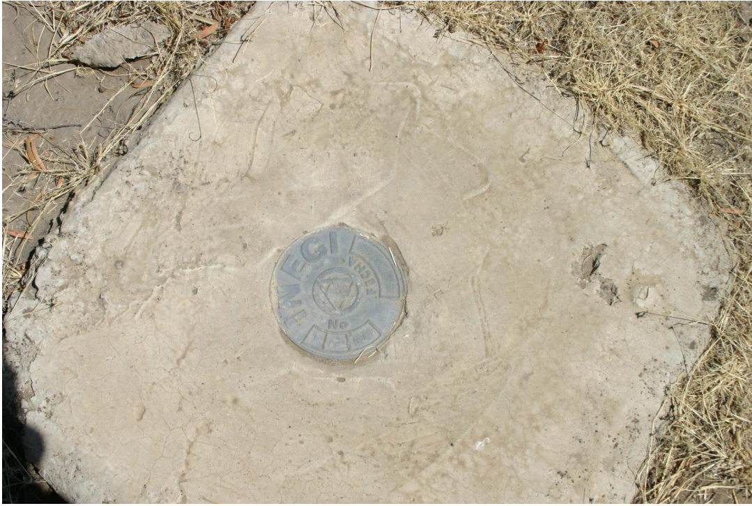
Figura 5. Placa del punto Geodésico de INEGI.
