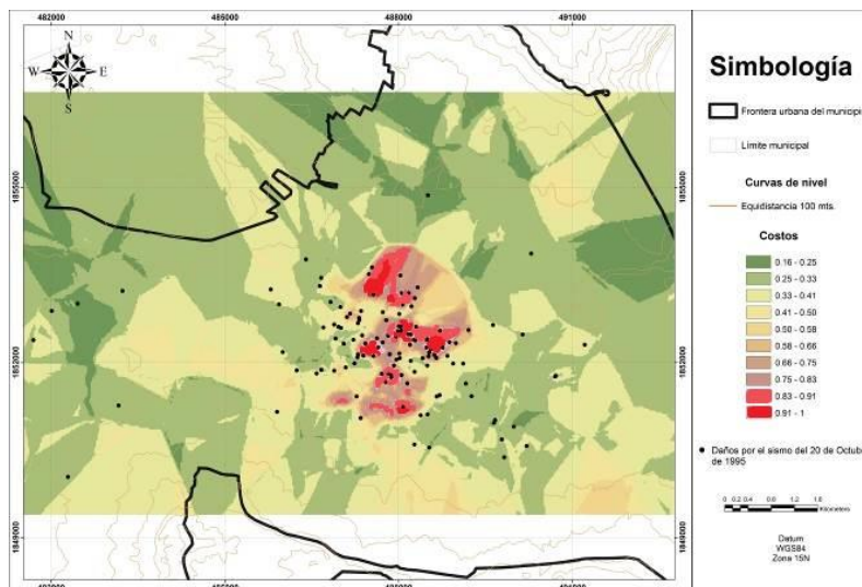
Figura 153. Comparación entre los daños del sismo del 21 de octubre de 1995 con respecto al escenario de SORIS para ese sismo. Los colores indican el índice de daño que va desde 0 (color verde), donde no hay daño, hasta 1 o pérdida total (color rojo).
