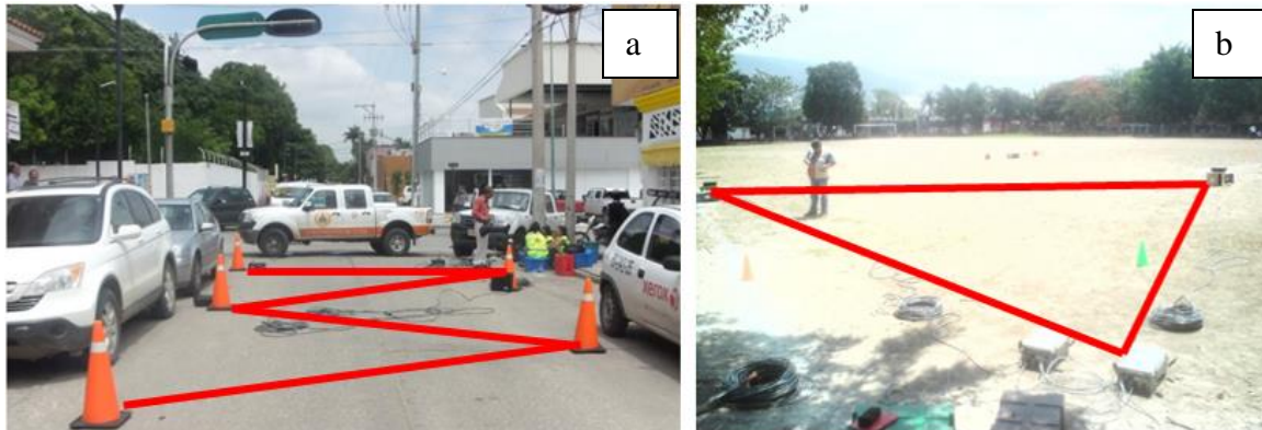
Figura 103. (a) Arreglo de Calicatas-SPAC en la avenida 1ª Norte entre 12 y 13 Poniente; (b) Arreglo SPAC en el campo de futbol de la facultad de Ingeniería de la Universidad Autónoma de Chiapas.
