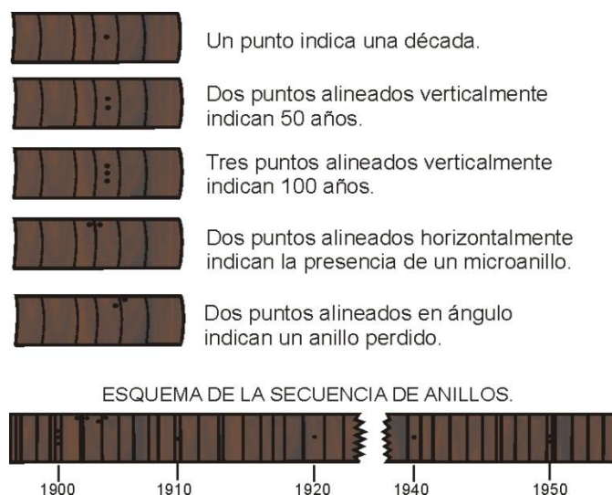
Figura 7. Conteo de anillos de crecimiento (Stokes y Smiey, 1996).
