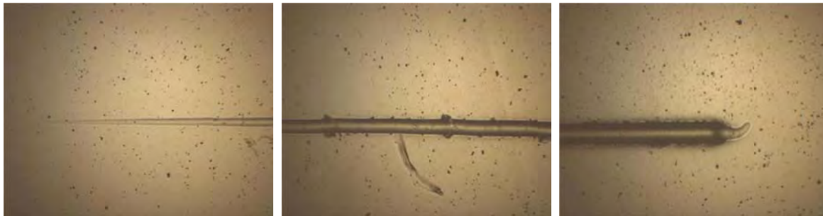
Figura 4-63. Prueba de Rayado para la película de NbN, sin inclusión de silicio
