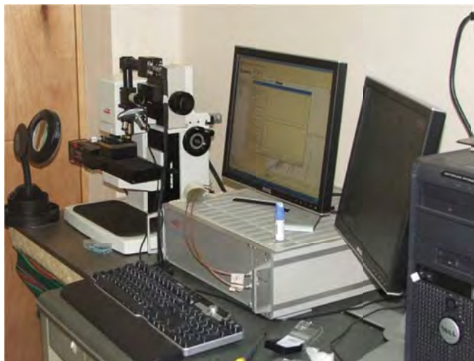
Figura 3-11. Sistema de nanoindentación
