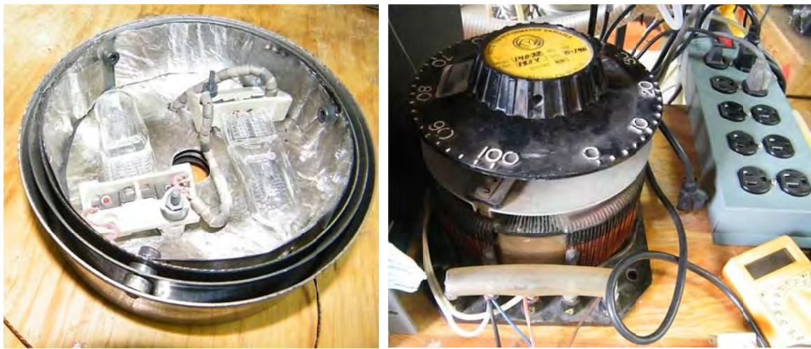
Figura 3-6. Calentador diseñado para aplicar temperatura a los sustratos
