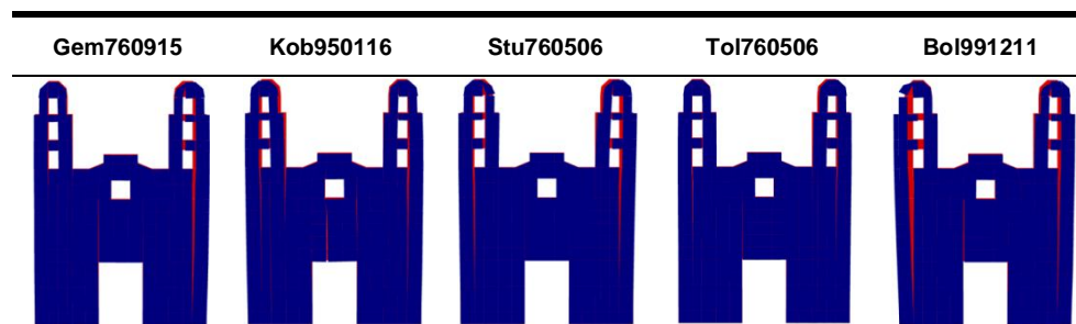
Figura 5.10. Estados de la fachada de Puebla al final del análisis de los casos Gem760915, Kob950116, Stu760506, Tol760506 y Bol991211.
